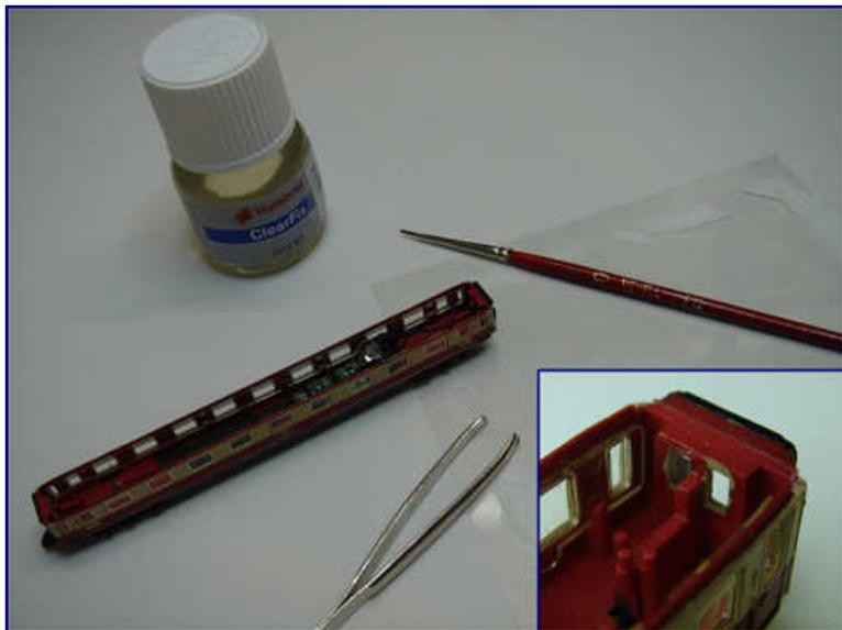
Die Folie für die Hinterglasung der Übergangstüren lieferte eine Pralineschachtel. Die passend zurechtgeschnittenen Stücke werden mittels „Clearfix“ von Humbrol angeklebt. Wichtig ist dabei, den Klarlack in kleinen Punkten auf dem Waggon aufzubringen und die Scheibe punktgenau aufzulegen (linkes Fenster im kleinen Bild).
