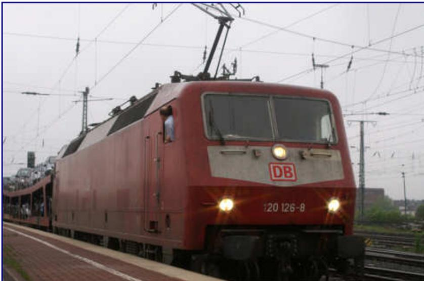
Höhepunkt und Abschluss des Jahrzehnts markiert entwicklungs-technisch die Baureihe 120, hier die Serienlok 120 126-8 im orientrotten Lack ihrer Auslieferung. Mit dieser Lok gelang es dank der modernen Leistungselektronik erstmals, mit vorhandener Infrastruktur die Drehstromtechnik im Bahnalltag zu nutzen. Ursprünglich sollte sie später die Universallok der Bundesbahn werden.
