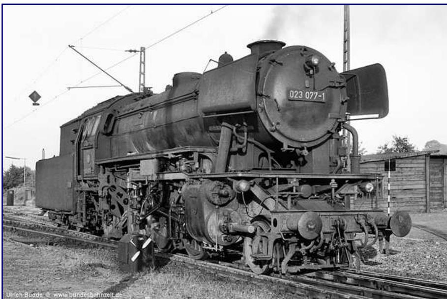
am Kohlenkasten sowie natürlich die nun bewährte Ausstattung mit Rollenlagern und Achsgleitplatten aus Hartmanganstahl beibehalten.
