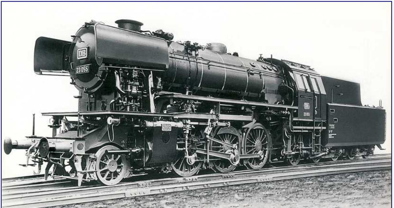
Die Maschinen der Vergabe 1954 erhielten endlich einen Mischvorwärmer. Zum Einsatz kam die Bauart Heini. Ebenfalls Standard war nun die Ausrüstung mit Rollenlagern, die eine Verstärkung des Rahmens erforderlich machte. Markant waren die Lokomotiven des Krupp-Bauloses – als einzige erhielten sie ein DB-Emblem auch an der Rauchkammertür. Foto: Krupp / Sammlung Ulrich Budde
