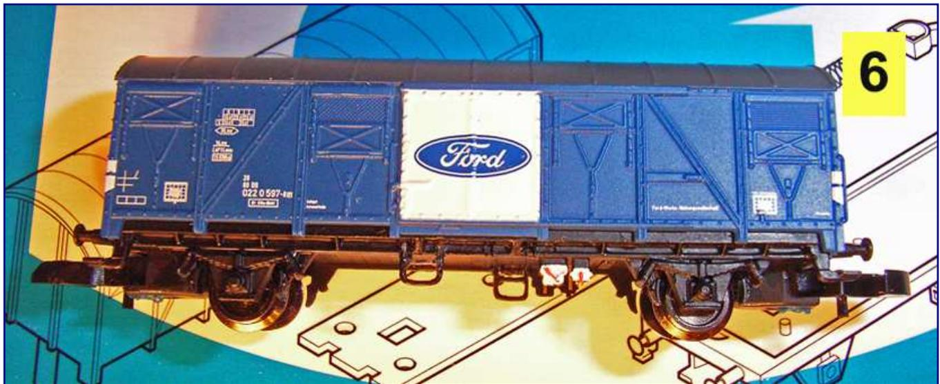
Schritt 6 – Zum Abschluss erfolgt die Montage gemäß Märklin-Anleitung. Brems- und Lastenhebel (rechts vom Aufstieg zu sehen) erhalten noch eine optische Hervorhebung durch weißen und roten Lack. Der Charakter des Wagens hat sich deutlich positiv verändert.
