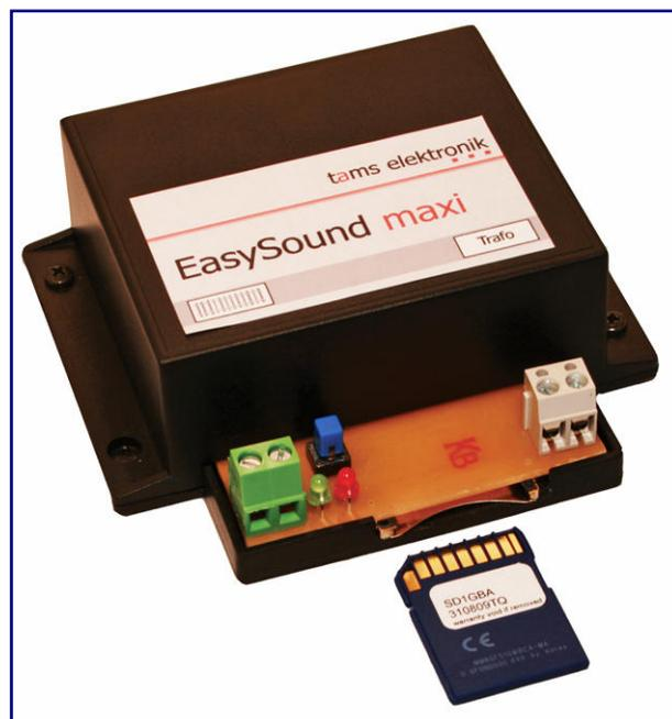
Als stationäres Gerät ist Tams' „EasySound maxi“ auch in Spur Z einsetzbar. Foto: Tams
