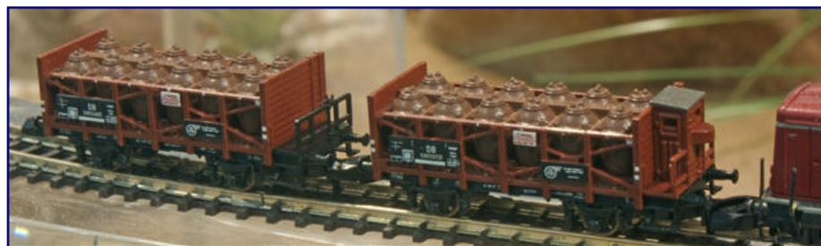
Diese beiden Handmuster der neuen Säuretopfwagen zeigen, wie fein Märklin den Aufbau und die Behälter in Spritzgusstechnik umsetzen will.
