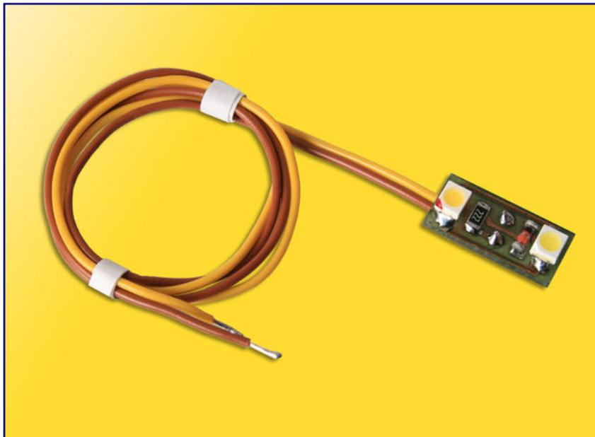
Die Hausbeleuchtungen mit LED in gelb (6017) und weiß (6018) werden samt Platine einfach unter das Dach geklebt und sorgen dort für eine wartungsfreie Beleuchtung ohne Wärmeentwicklung. Wer dort bislang Beleuchtungssockel eingesetzt hat, kann solche mit Fassung E 5,5 nun auf LED-Technik umrüsten: Möglich macht dies die LED-Leuchte mit Gewindefassung (6019), die dank eines Prismas rundum weißes Licht abgibt.
