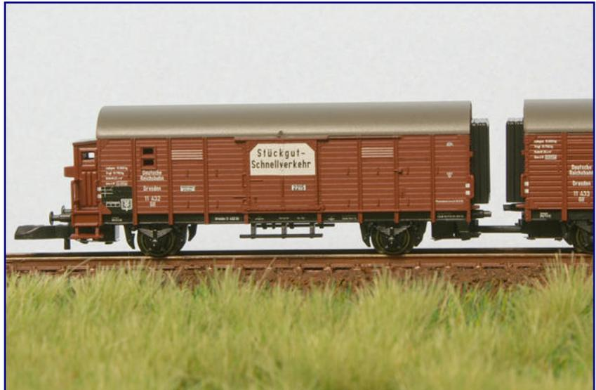
Recht unauffällig ist die Kurzkupplung zwischen den Wagen. Korrekt sind die einfachen Puffer und Stoßflächen zwischen den Wagen, die im Vorbild erst das Kurzkuppeln ermöglichten.
