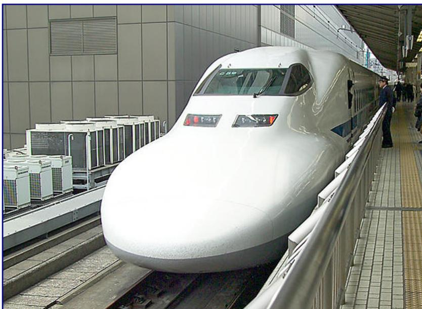
Die Tokaido-Shinkansen-Züge der Baureihe 700 tragen eine optimierte Nase gegen den Tunnelknall. Beim Halt im Bahnhof Tokio ist auch das nahezu viereckige Grundprofil der Wagen gut zu erkennen. Foto: Frank Gualtieri † (PD)
