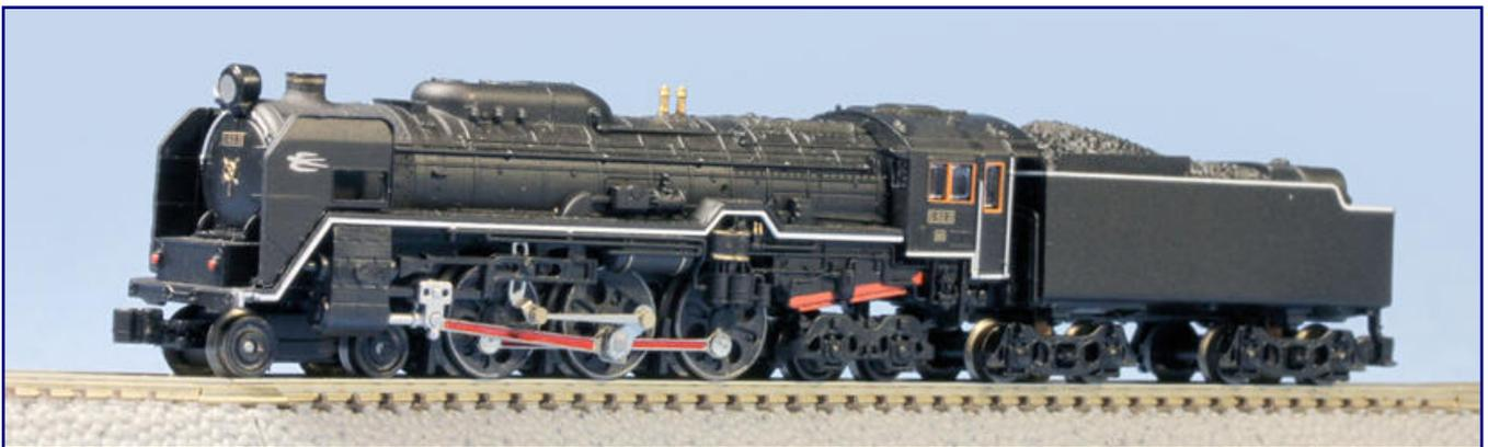
Drei Formvarianten standen bei Tenshodo von der Mikado-Dampflok D51 zur Auswahl, deren Unterschiede auf Antrieb auffielen (Bild oben). Auch von der Schlepptenderlok C62 mit der Achsfolge 2'C2' produzierte Tenshodo drei Ausführungen, die sich aber nur in Farbgebung und Beschriftung unterschieden. Gleich war für beide Dampflok-Konstruktionen der Antriebsmechanismus mittels Kardanwelle vom Motor im Tender zu den Kuppelrädern. Fotos: **Ztrack** (Bild oben) / Tenshodo (Bild unten)
