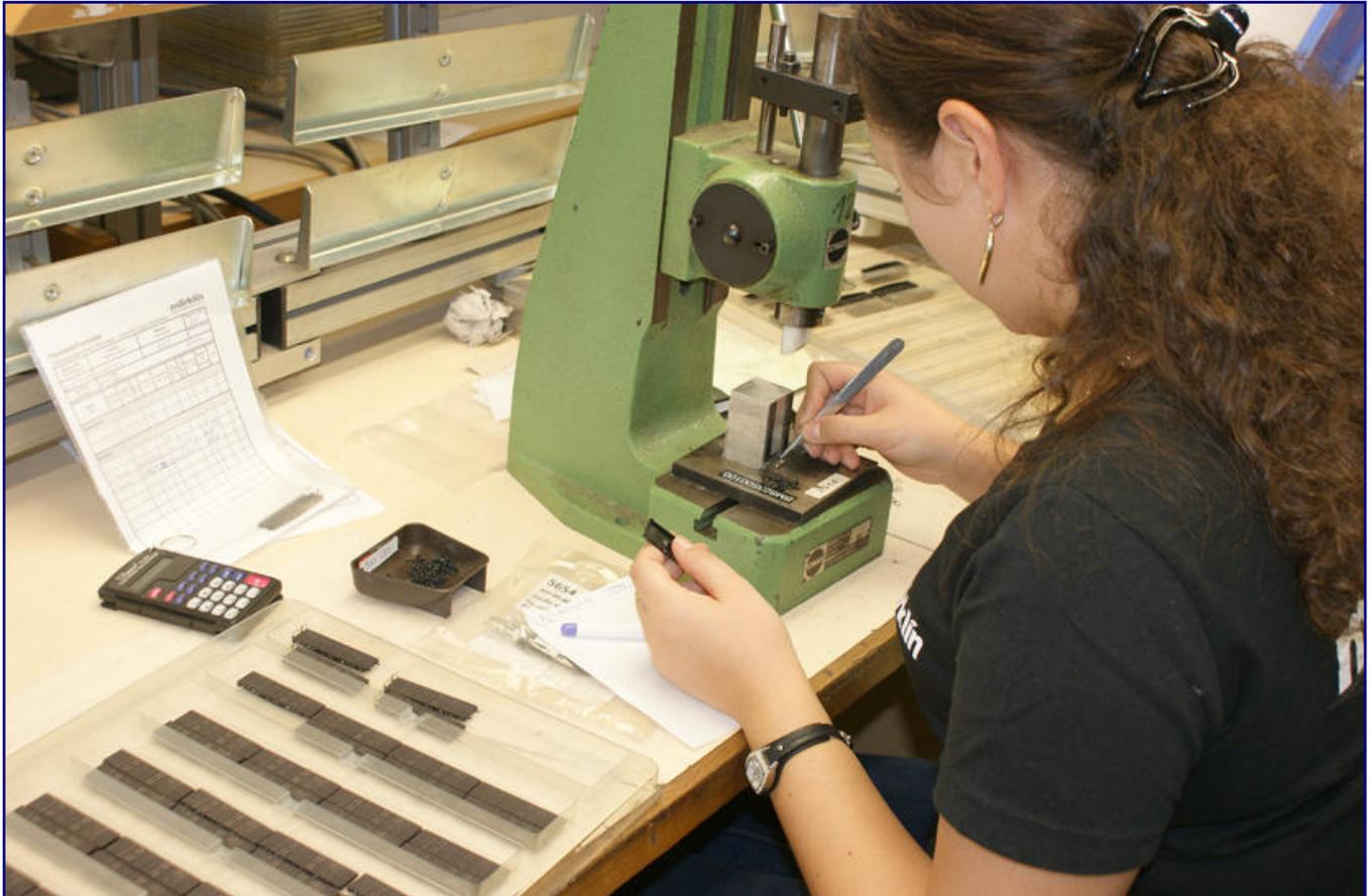
Während unseres Besuches befanden sich unter anderem die Schwerlastwagen der Packung 82349 in der Waggonmontage. Hier werden die Puffer in das Gussteil eingesetzt und die Bremserbühne aufgesetzt.
