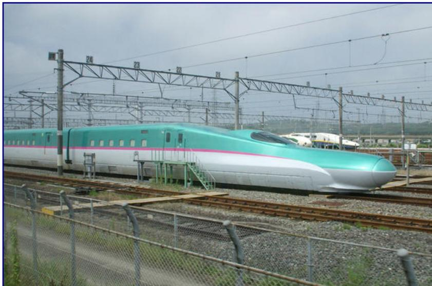
Ein Vorserienzug Reihe E5 der JR East mit seinem extrem stromlinienförmigen Entenschwanz steht am 25. Juli 2009 im Shinkansen-Hauptdepot Sendai. Foto: DAJF (CC BY-SA 3.0)
