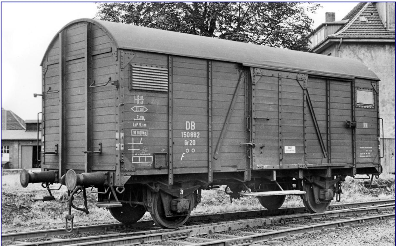
Die ab 1927 gefertigten Güterwagen der Verbandsbauart basierten auf der Austauschbauart (späterer G 10), die sie ablösen sollten. Am Fahrwerk und der Anordnung von Schiebern und Lüftern lässt sich dies deutlich ablesen. Wesentlicher Unterschied zu den Vorgängern war das stark gewölbte Tonnendach, das auch an diesem Gr 20 der DB deutlich zu sehen ist. Er wurde 1957 auf dem Gelände des BZA Minden auf Zelluloid festgehalten. Foto: Bustorff, Archiv Eisenbahnstiftung
