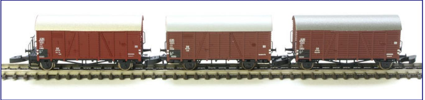
Um den Unterschied im Fahrwerksbereich deutlich zu machen, haben wir den Gr 20 (Mitte) neben zwei „Oppeln“ gestellt. Der deutlich kürzere Achsstand und das fehlende Sprengwerk sind nun nicht zu übersehen.
