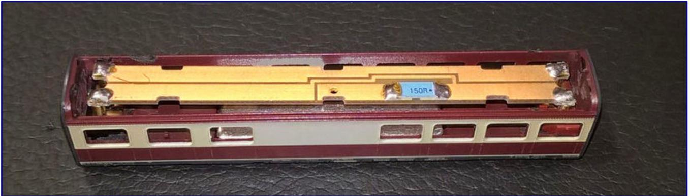
**Probezusammenbau:** Noch sitzt die Platine etwas schief, was aber keine Probleme beim weiteren Zusammensetzen und der sich anschließenden Fahrt auf der Anlage bereitet. Foto: Torsten Scheithauer
