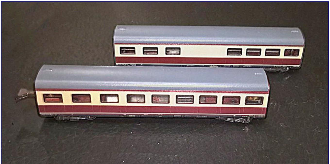
Das Motto des Umbaus lautet „Aus zwei mach eins“. Vorne im Bild ist der Originalwagen aus der Erweiterungspackung 87933 zu sehen, dahinter der Barwagen mit korrekter Form aus der früheren Packung 8793. Foto: Torsten Scheithauer
