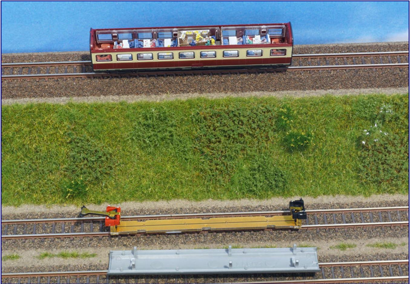
Jetzt ist nur noch die Beleuchtungsplatine mit den Kupplungsaufnahmen wieder einzusetzen und das Dach aufzustecken, dann ist der Umbau beendet und der Waggon den Betrieb aufnehmen.
