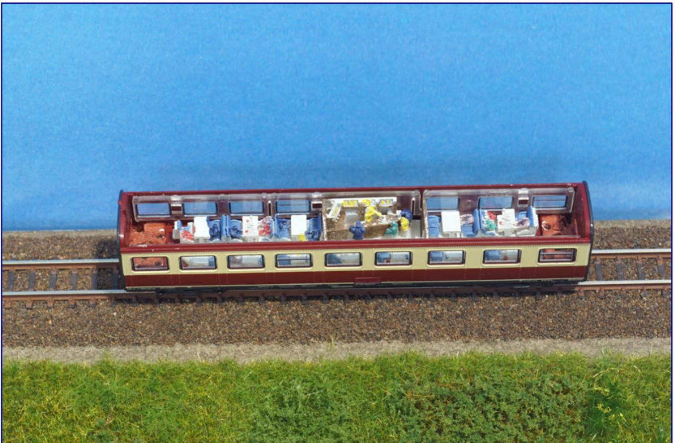
Der Barwagen aus Torsten Scheithauers Umbau erhält auch noch eine 3D-Druck-Inneneinrichtung mit Figuren. So kann die Innenbeleuchtung volle Wirkung entfalten.
