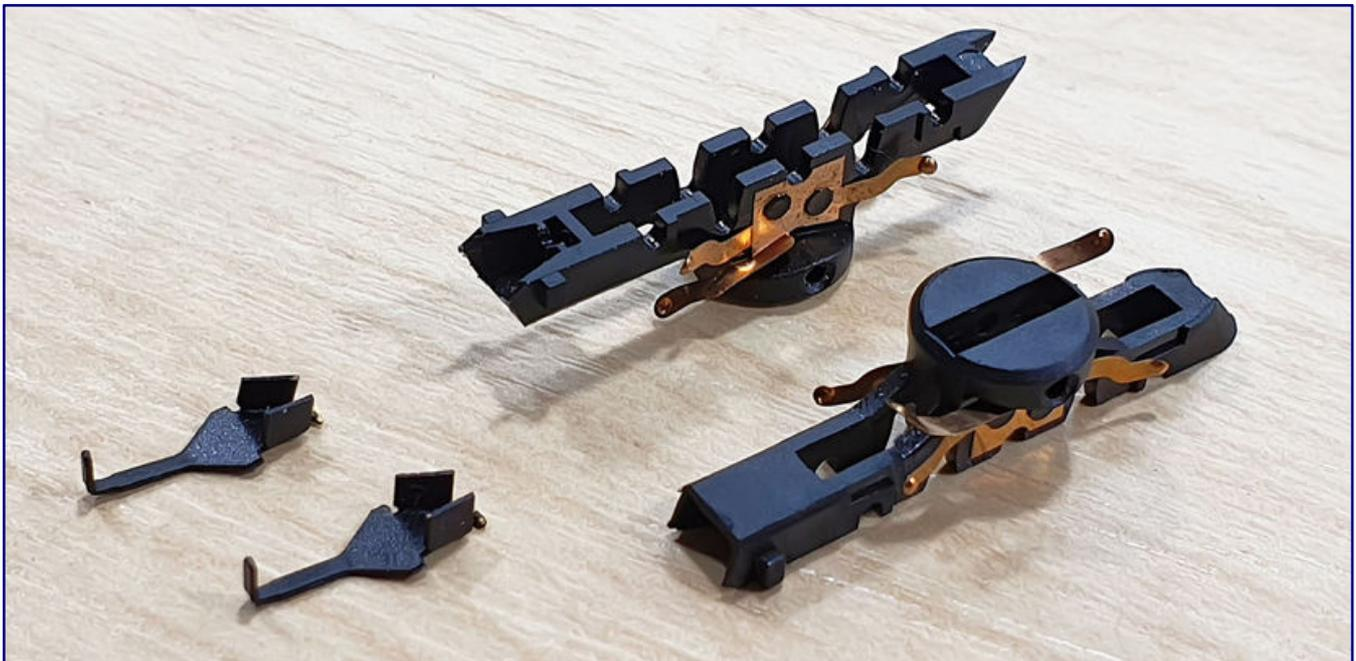
Um die Schürze des Vorbilds nachbilden zu können und das Modell beidseitig kupplungsfähig zu halten, war eine Sonderlösung erforderlich. Ähnlich den Lokmodellen von FR Freudenreich Feinwerktechnik erhielten die „Taugatrommeln“ einen Kupplungshaken aus gebogenen Ätzblechen, die in den Kupplungsschacht der Drehgestellrahmen montiert werden.
