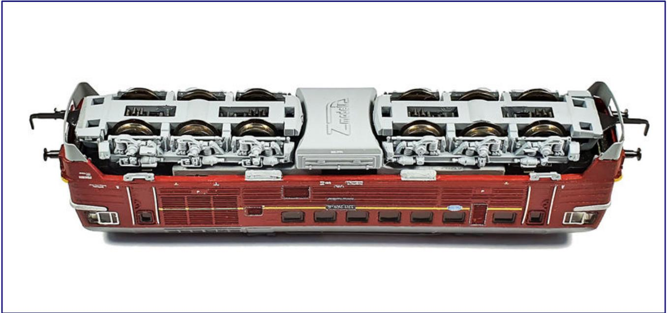
Die Ansicht von unten verdeutlicht die Führung des Kupplungshakens im Drehgestell und das Erfordernis einer Schürze mit Schlitz für ausreichend Bewegungsfreiheit.
