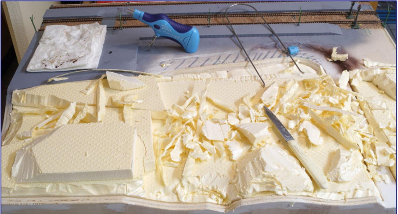
Die endgültigen Strukturen der Landschaft werden mit einem scharfen Messer, dem 3-in-1-Multitool mit zwei unterschiedlichen Aufsätzen sowie Schleifpapier ausgearbeitet. Danach ist erst einmal gründliches Absaugen angesagt, bevor es weitergehen kann.
