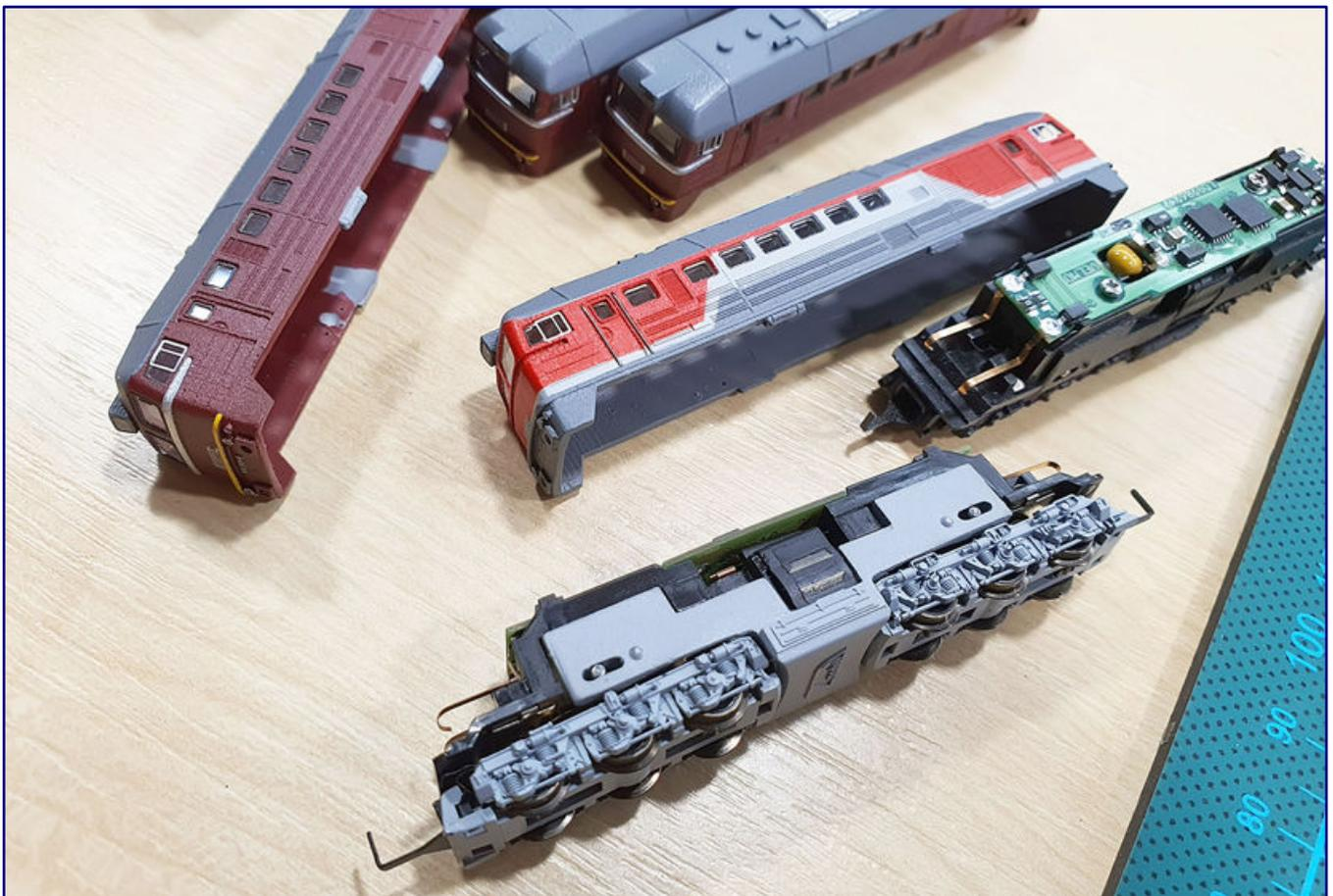
Fahrwerke und Drehgestelle basieren auf Teilen von Märklin: Das Fahrwerk spendete die elektrische Lokomotive der Baureihe 243 (ab 1992: 143) und wurde an den Kunststoffteilen etwas eingekürzt. Der Gussblock zwischen den Rädern musste abgefräst werden und erhielt eine Abdeckung. Die Drehgestelle stammen von der Ludmilla.
