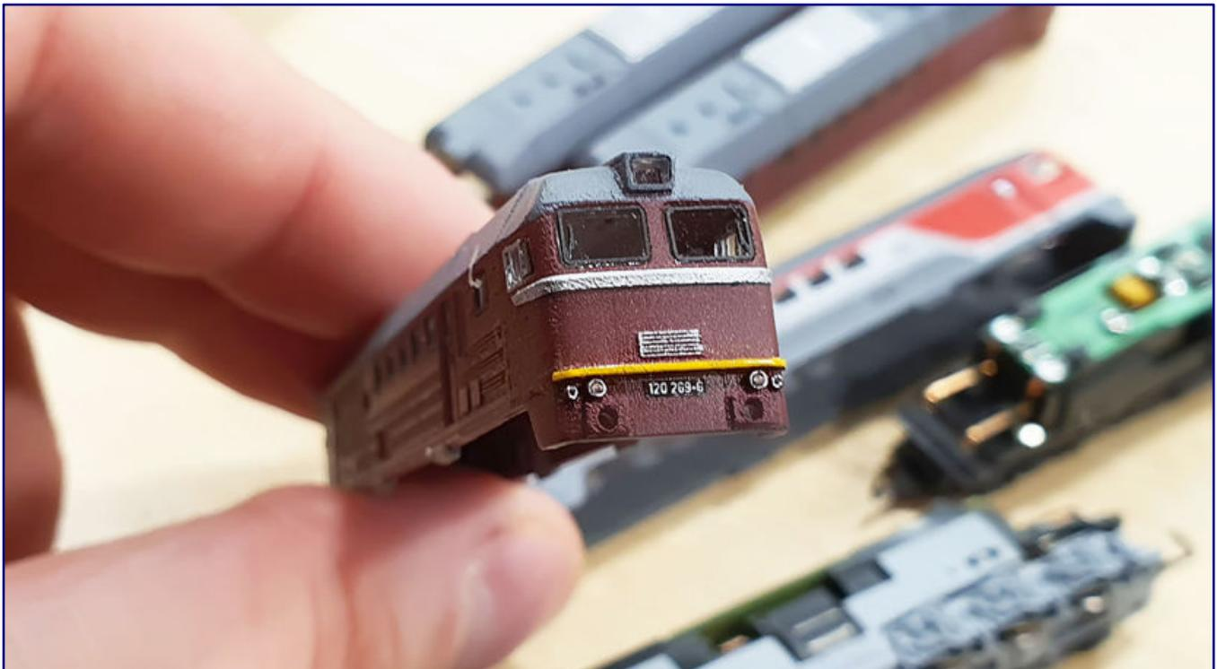
Um die Spitzenlichter funktional ausstatten zu können, wurden unten die beiden inneren Laternen sowie die trapezförmige, obere aufgebohrt. Das obere Licht musste anschließend noch eckig aufgefleilt werden, während die äußeren Schlusslichter unten im Modell ohne Funktion blieben. Aus Glasfasermaterial und Polystyrol entstanden anschließend die Einsätze, die auch die Funktionen eines Lichtleiters übernehmen.
