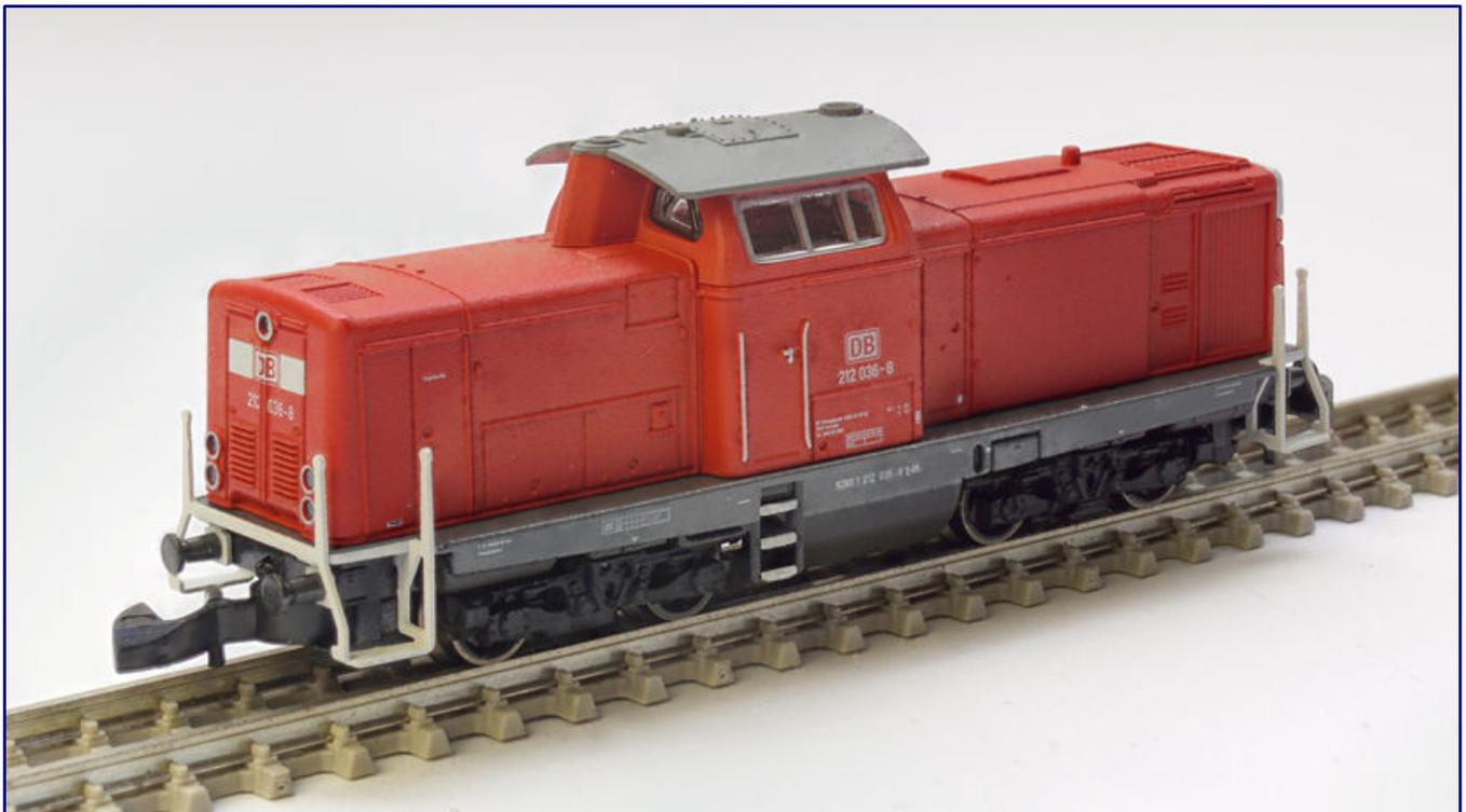
Mit der 212 036-8 von DB Fahrwegdienste (Art.-Nr. 88217) hat Märklin ein weiteres Modell der V 100 in Verkehrsrot ausgeliefert. Technisch ist es mit einem Glockenankermotor auf dem neuesten Stand.
