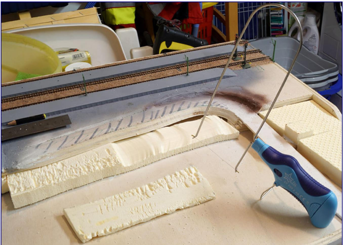
Die große XPS-Platte wird mit Hilfe einer Dekupiersäge in kleinere Stücke vorgeschritten. Die Maßarbeit gelingt hervorragend mit dem 3-in-1-Multitool (ST 103) von Star Tec Products: Mit ihm lassen sich Platten dünner schneiden, Schrägen einarbeiten, aber auch kleinere Stücke vom Block abtrennen.
