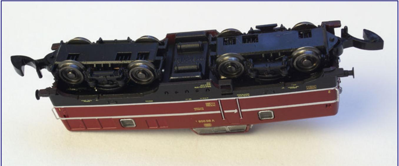
Der Blick auf die Unterseite verweist schon durch die offen liegenden Zahnräder auf einen neuen Aufbau. Für den bislang bekannten Kupplungsschacht hätten die Drehgestelle nicht ausreichend Raum geboten oder einen sichtbaren Kompromiss im Fahrwerksbereich verlangt.
