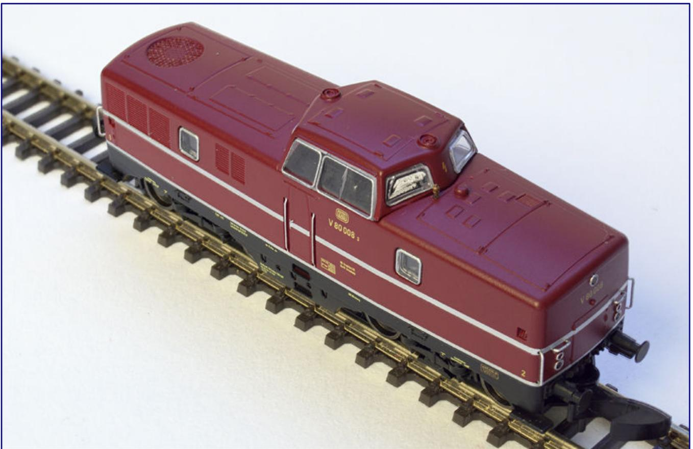
Das Modell bietet neben gelungenen Proportionen teilweise auch einen Durchblick durch die Maschinenraumfenster (Bild oben). Zu überzeugen wissen uns auch die Gravuren der Maschinenraumklappen, des abgedeckten Lüfterrads und der kleinen Lüftungklappen auf dem Führerstandsdach und dem kurzen Vorbau.
