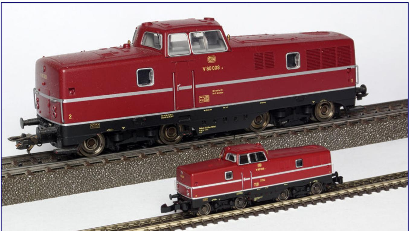
V 80 008 steht ihrer größeren Schwester im Maßstab 1:87 (36082) in keiner Weise nach: Die Unterschiede beschränken sich beinahe auf das im größeren Maßstab stärker angedeutete Führerstandsinnere, die unterschiedlichen Systemkupplungen und Spurkranzhöhen.
